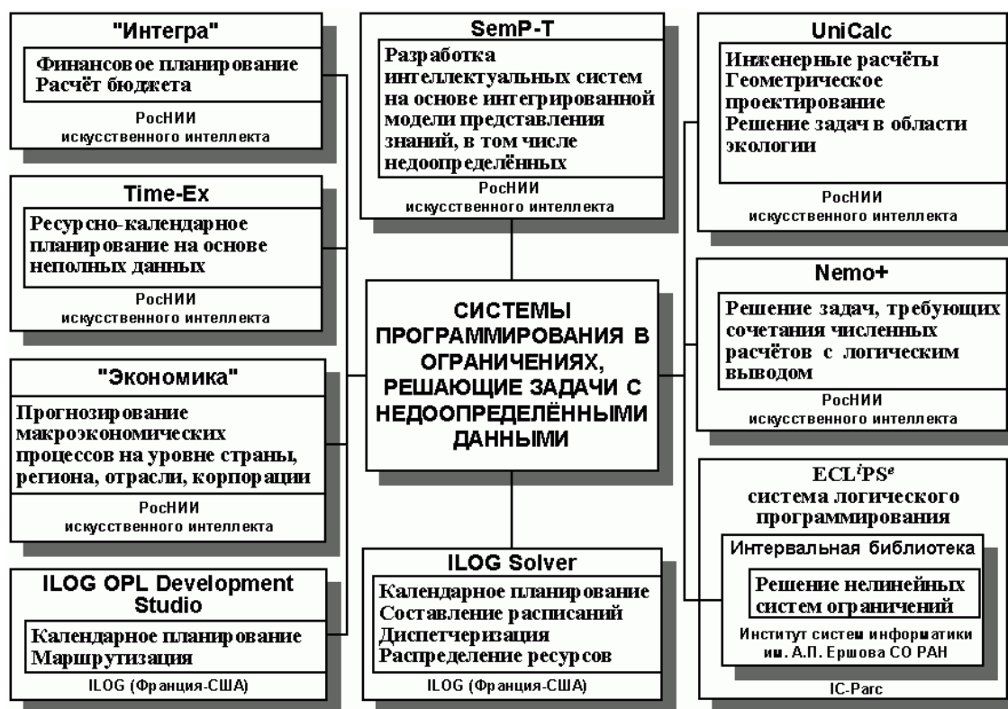
Рис. 1. Системы программирования в ограничениях, решающие задачи с недоопределёнными данными, и области их применения.
