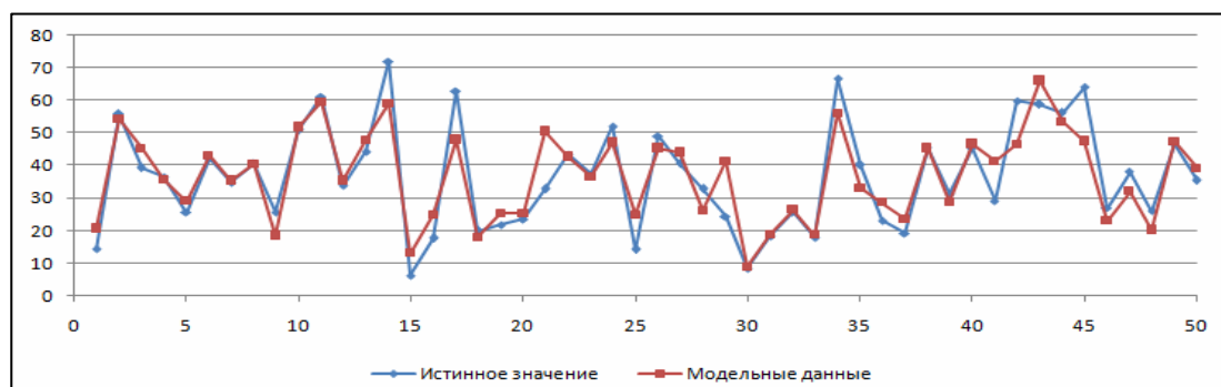
Рис. 3. Значения предела прочности бетона, полученные на нейросетевой коллективной модели, и истинные измеренные значения в точках экзаменующей выборки
