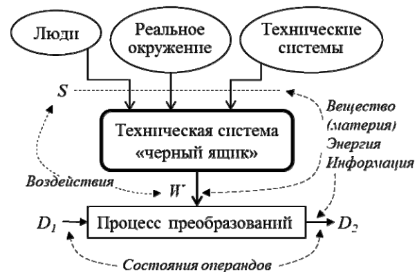
Рис. 2. Модель технической системы в виде «черного ящика»
