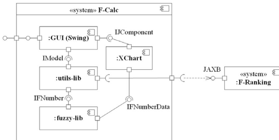
Рис. 2. UML-диаграмма компонентов разработанной системы *F-Calc* и ее взаимодействие с системой *F-Ranking*
