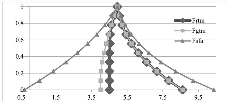
Рис. 9. Результат вычисления функции  $F(Z_1, Z_2)$  с использованием RTM ( $F_{rtm}$ ), GTM ( $F_{gtm}$ ) и СНА ( $F_{sfa}$ ) (правая граница  $F_{rtm}$  совпадает с правой границей числа  $F_{gtm}$ )
