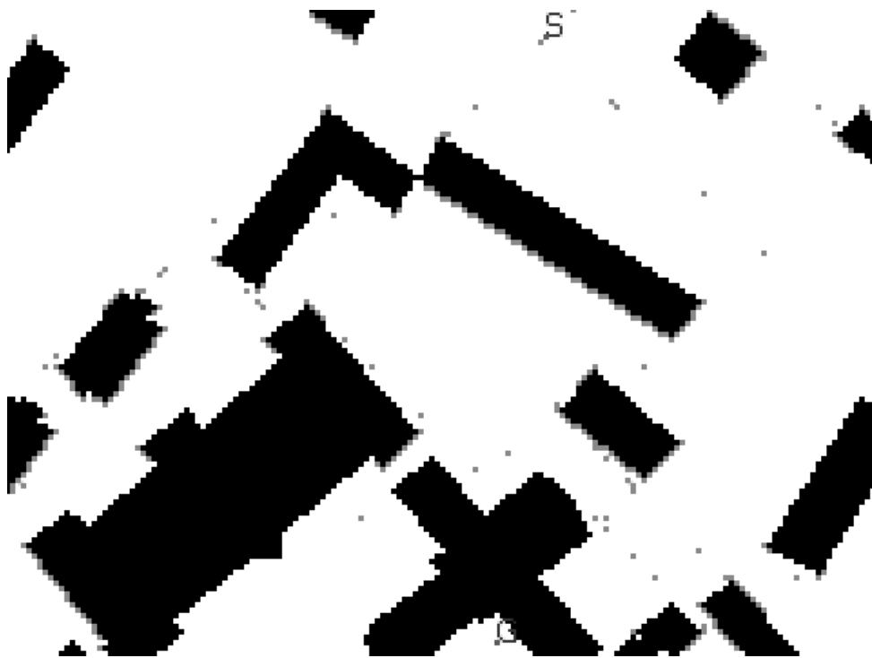
Рис.5 – Черным цветом отмечены непроходимые области – препятствия, серым – опорные вершины, которые алгоритм сохранил в памяти
