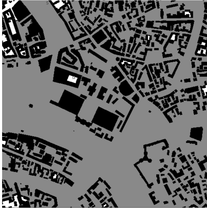
Рис.2 – Черным цветом отмечены непроходимые области – препятствия, серым – области, которые были исследованы алгоритмом в процессе поиска, белым – области, недостижимые из начальной вершины
