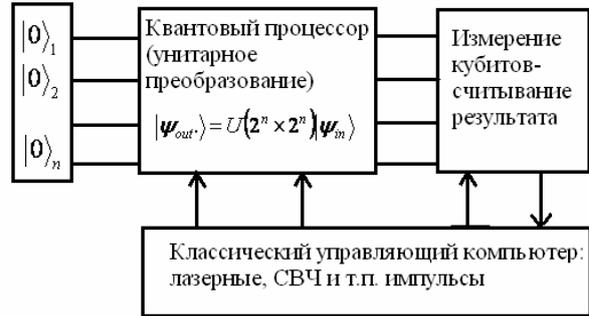
Рис. 5. Блок-схема идеального квантового компьютера
