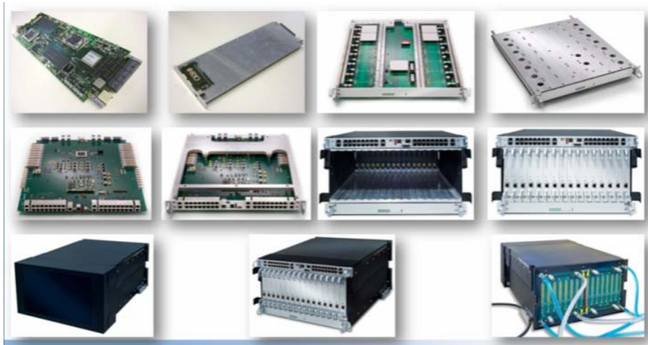
Рис. 3. Основные модули и узлы вычислителя суперкомпьютеров «СКИФ» ряда 4
