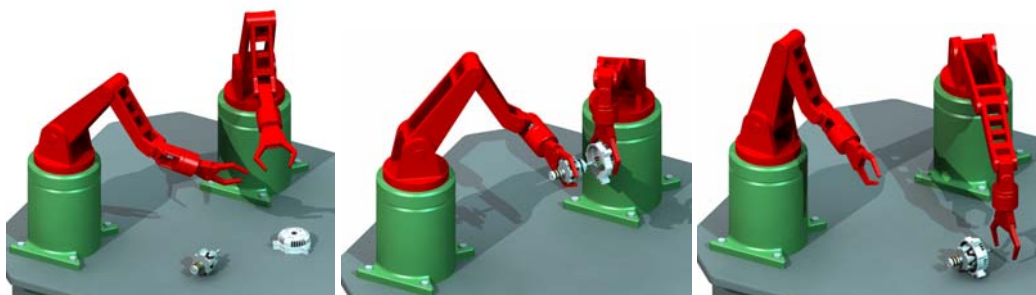
Рис. 6. Моделирование виртуальной сборки генератора
