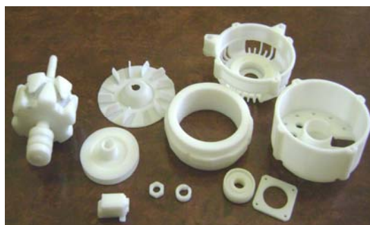
Рис. 5. Физические модели изделий, полученные на 3D-принтере
