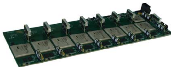
б) плата вычислительного модуля «Ригель» на основе ПЛИС семейства Virtex 6
