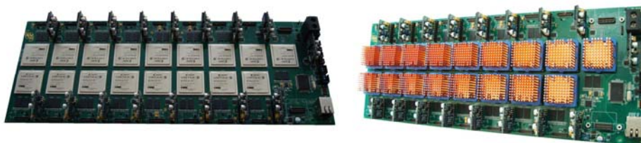
а) плата вычислительного модуля «Орион-5» на основе ПЛИС семейства Virtex 5
