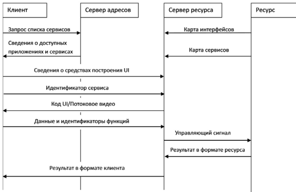
Рис. 1. Схема передачи управляющих сигналов и данных
