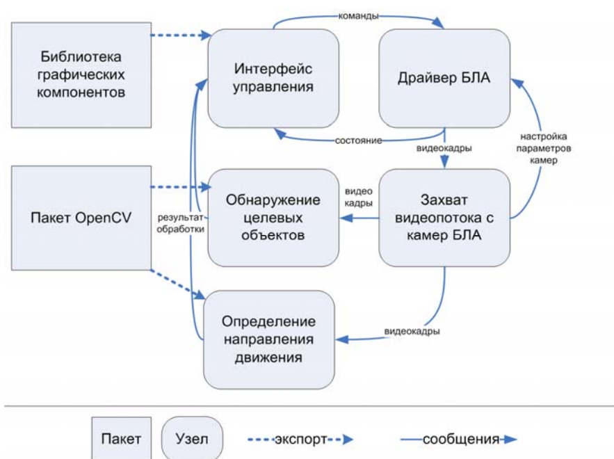
Рис. 2. Программная реализация системы управления (тактический уровень) на базе ROS
