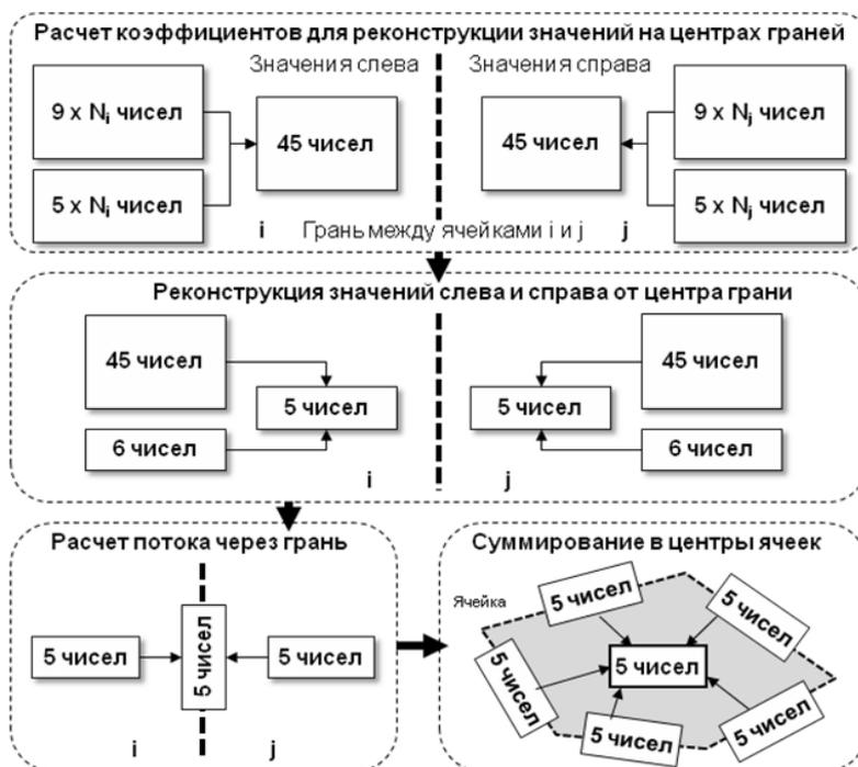
Рис. 2. Шаблон доступа к данным при расчете потоков через грань ячейки
