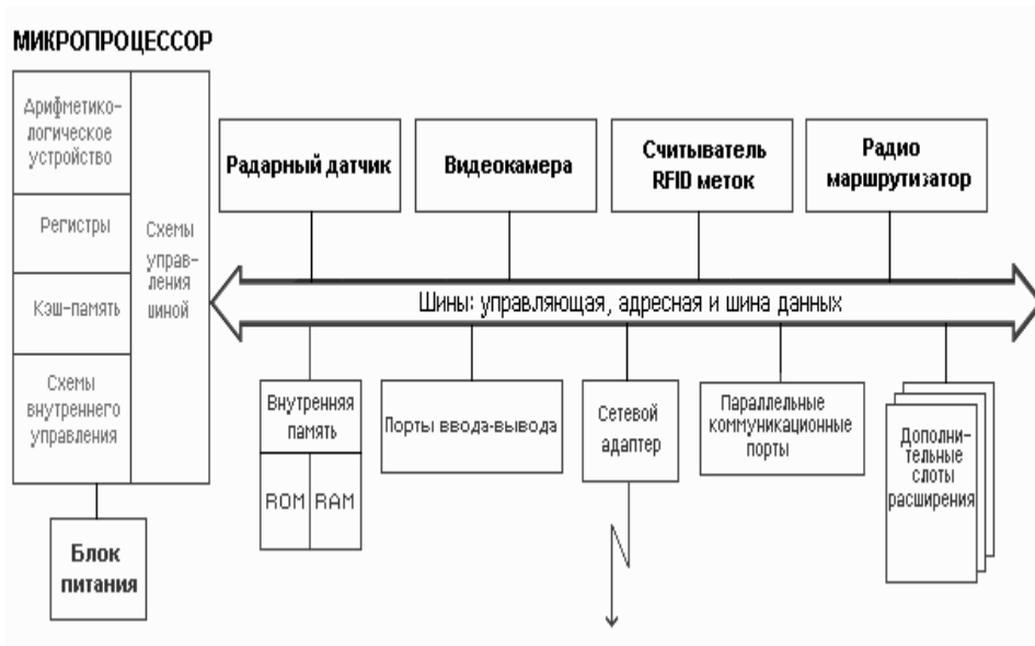
Рис.2. Архитектура основного аппаратного модуля идентификации
