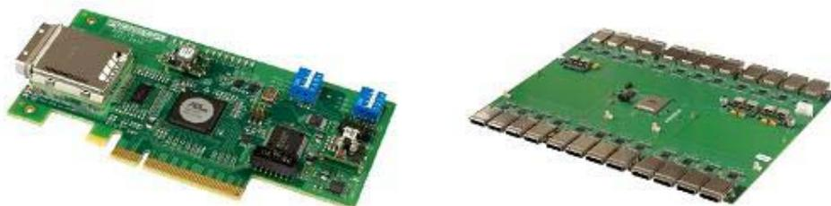
Рис.2 Интерфейсная плата и плата коммутатора сети МВС-Экспресс
