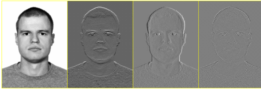
Рис. 1. Пример извлечения признаков лица для классификатора Виолы-Джонса: исходное изображение лица и результат применения вейвлет-преобразования Хаара
