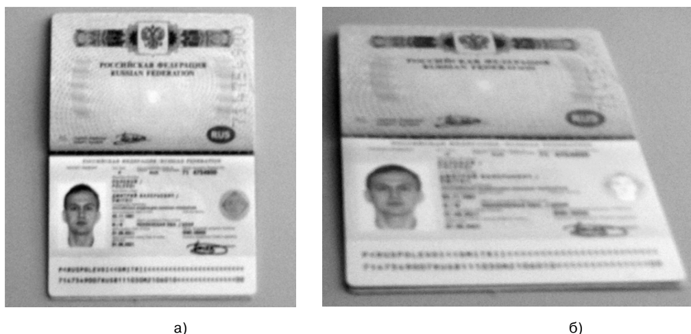
Рис.5. Примеры а - слабого и б - сильного проективного искажения
