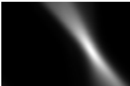
Рис. 15. Преобразование Хафа сглаженного пространства коэффициентов для преимущественно горизонтальных прямых
