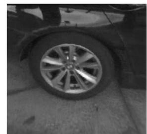
Рис. 22. Колесо с ребрами жесткости
