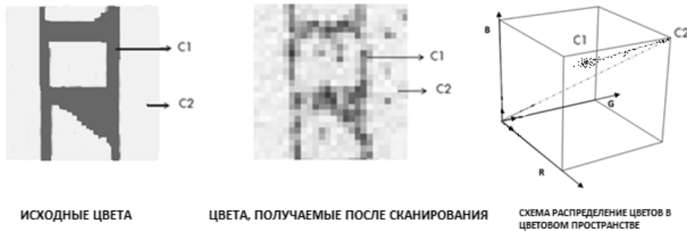
Рис. 8. Схема распределения получившихся цветов в цветовом пространстве
