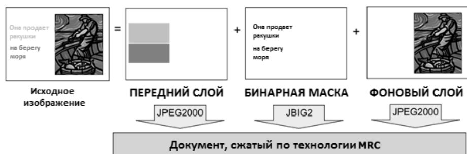
Рис. 1. Схема работы MRC
