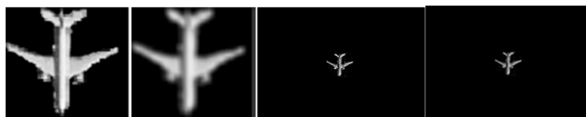
Рис.3. Слева направо: эталон и соответствующий опорный ориентир с устраненными взаимными невязками, выбранные на соответствующих паттернах изображения и отфильтрованные от фона; далее эталон и соответствующий опорный ориентир, помещенные в рабочий фрейм и приведенные к виду инвариантному к углу места солнца
