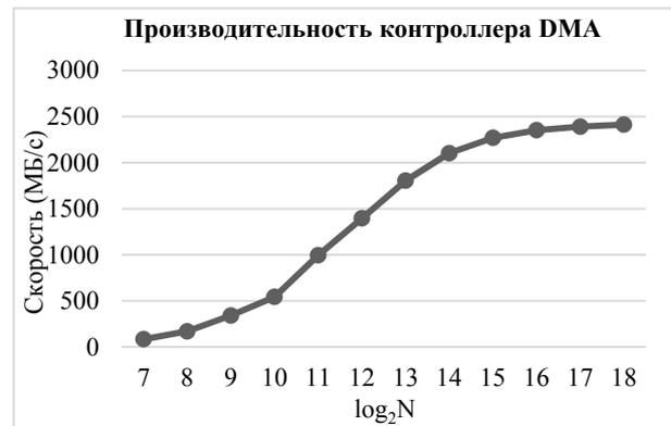
Рис. 7. Производительность контроллера DMA BM7 с DDR2 RAM PC2-3200 (DDR2-400), на частоте 200 МГц; N — объём данных в Байт, пиковая скорость передачи данных 3200 МБ/с
