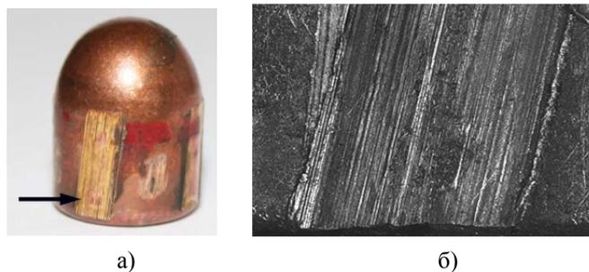
Рис.1. След от поля нареза канала ствола на выстреленной пуле
