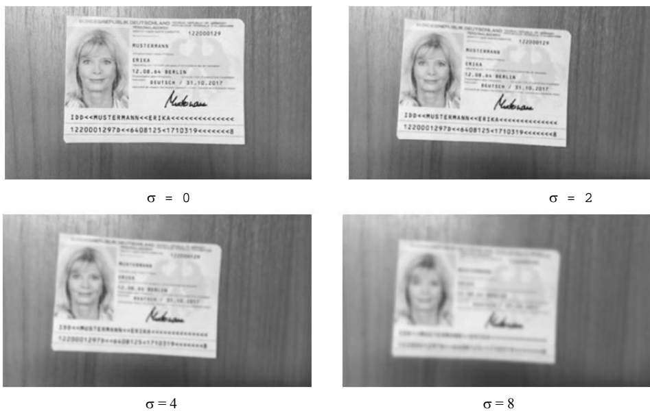
Рис. 6. Пример моделирования процесса автоматической фокусировки для видеопотока
