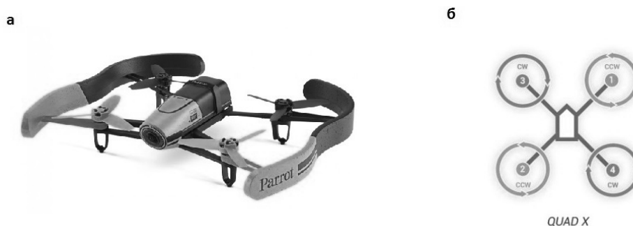
Рис. 1. а) Малый беспилотный летательный аппарат мультироторного типа Bebop Drone; б) схема расположения двигателей БПЛА
