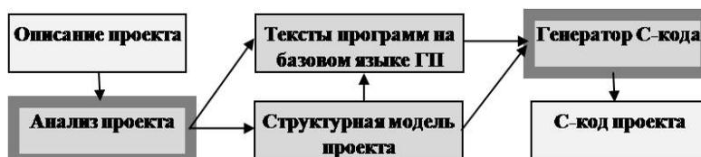
Рис. 3. Последовательность автоматической генерации программного кода проекта
