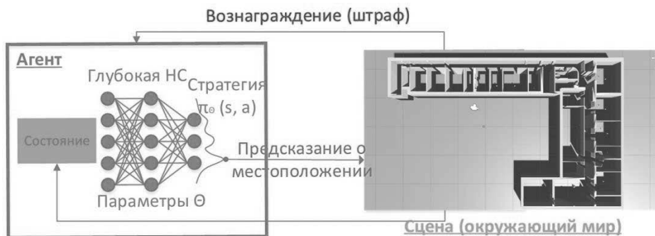
Рис. 5. Схема глубокого обучения с подкреплением для системы проактивной локализации
