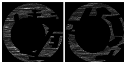
Рис. 8. Изображения поверхности капсюля на стреляных гильзах после удаления областей, не содержащих следов патронного упора
