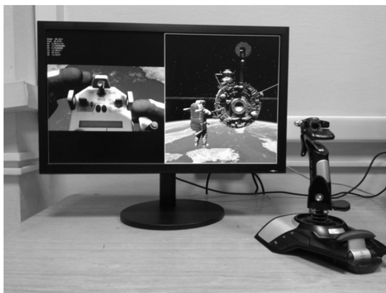
Рис. 5. Стенд управления моделью космонавта с помощью джойстика
