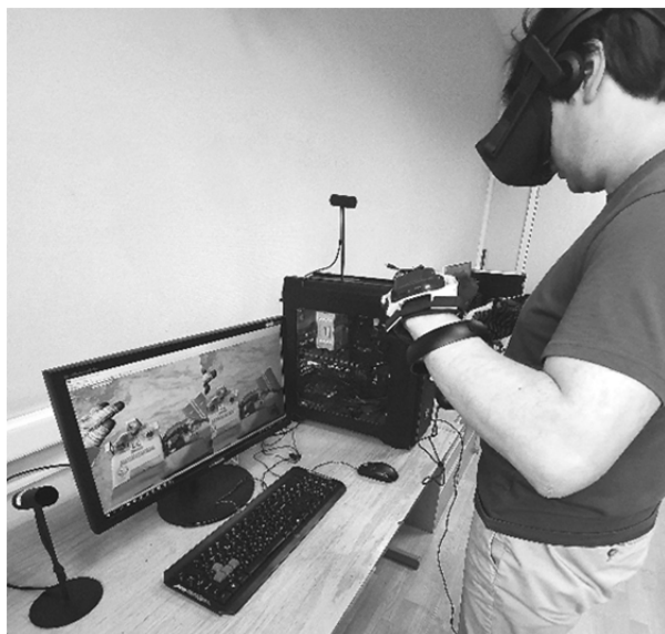
Рис. 7. Тренировка оператора с применением Oculus Rift, Oculus Touch и Manus Prime II
