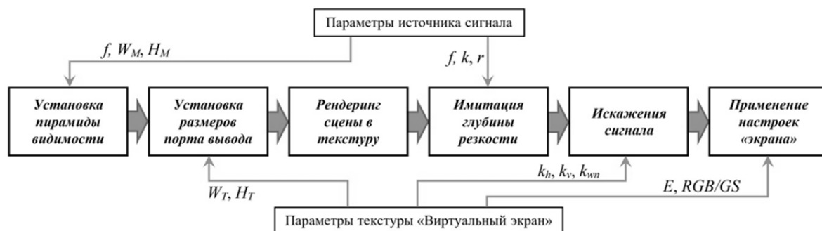
Рис. 2. Схема синтеза изображения для текстуры "Виртуальный экран"
