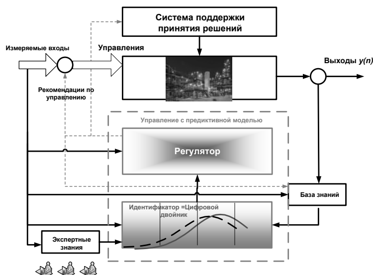
Рис. 1. Идентификатор в контуре обратной связи системы управления как ЦД
