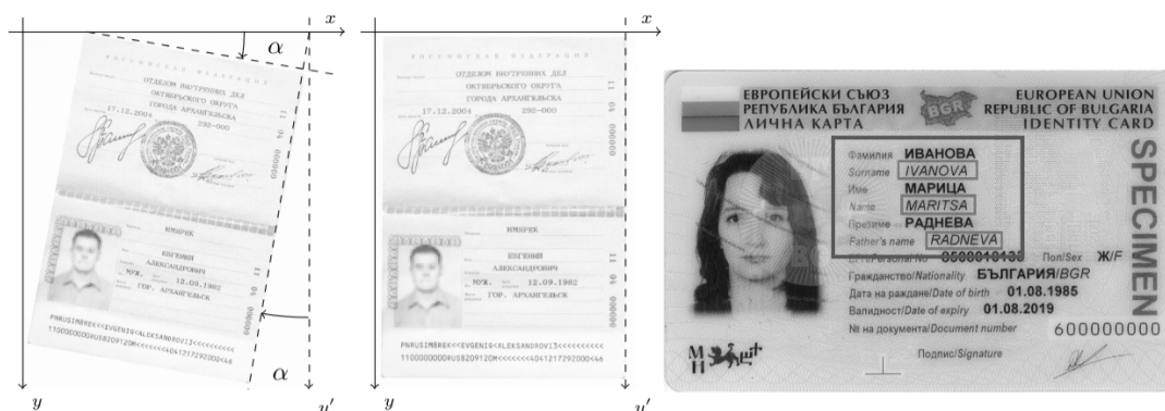
Рис. 1. Цифровой образ паспорта РФ: слева – до компенсации наклона; по центру – после; справа – пример ID карты Болгарии с текстовыми фрагментами наклонного начертания
