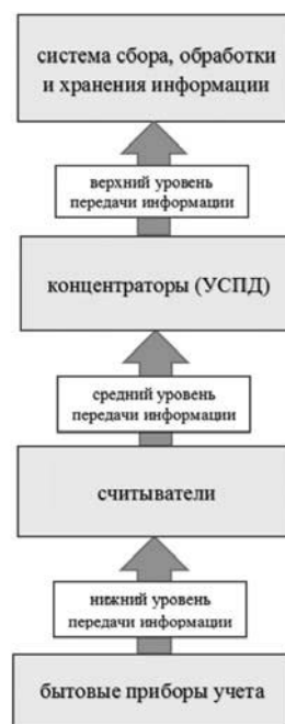
Рис. 1. Общая структурная схема автоматизированной системы мониторинга показаний бытовых приборов учета
