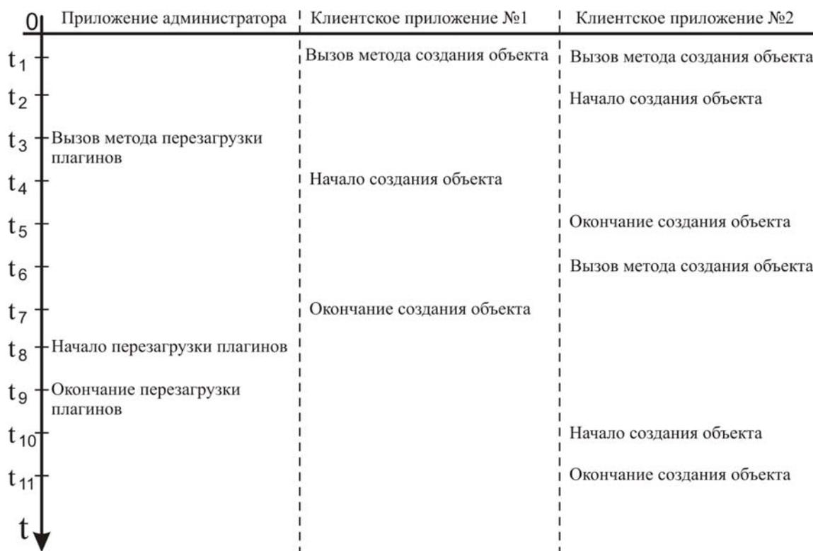
Рис. 1. Оптимальная последовательность обработки вызовов на СП
