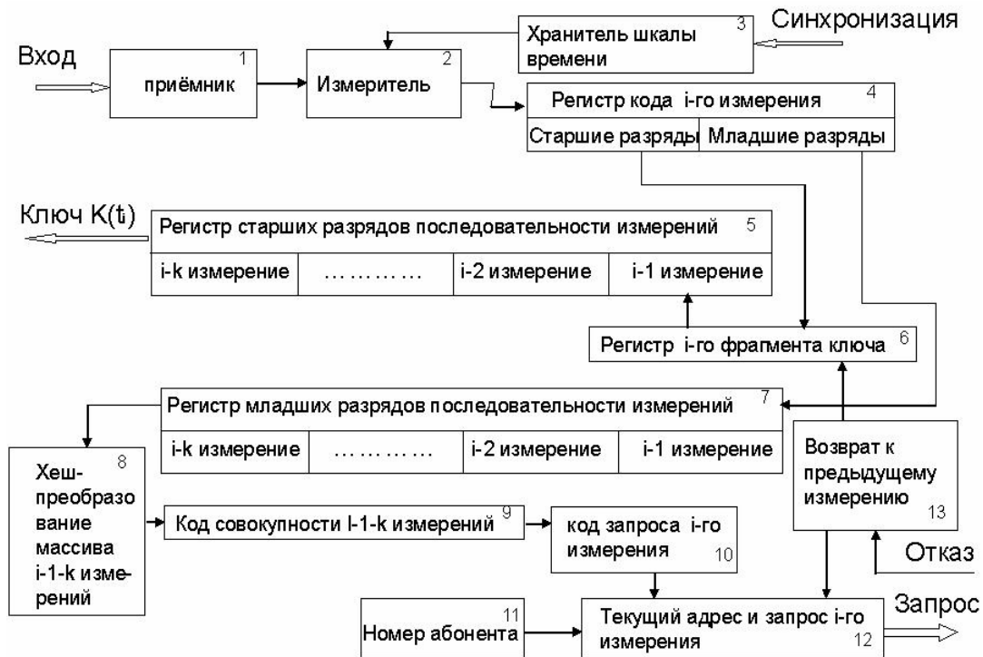
Рис 3. Функциональная схема формирования ключа, его проверки и аутентификации абонентов в системе МК
