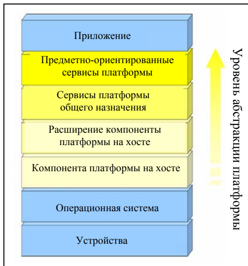
Рис. 1. Архитектура платформы, рассматриваемая в проекте Angel
