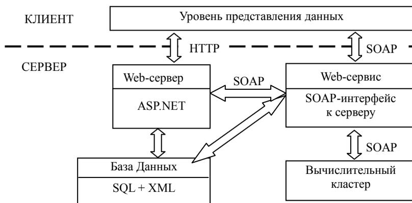
Рис. 4. Архитектура Web-СПЭР
