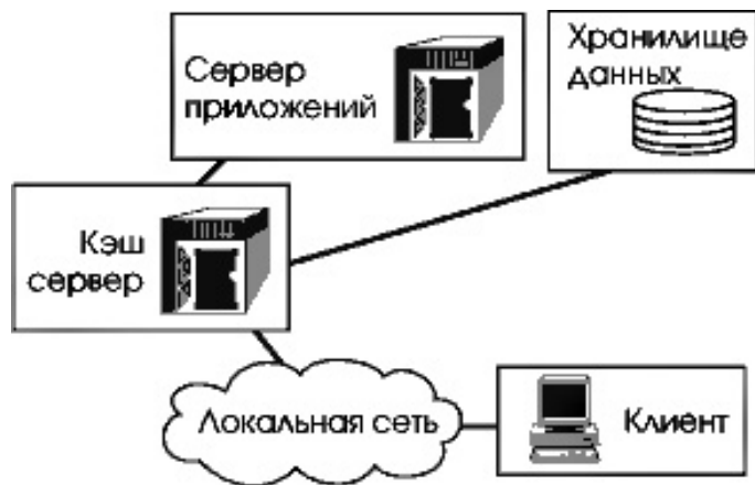
Рис. 16. Схематическое изображение архитектуры NAS. Качество Услуг (QoS). Обеспечение QoS в сетевых сообществах
