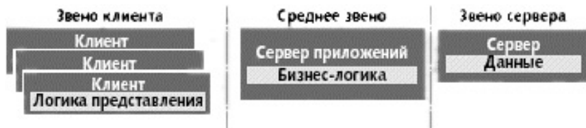
Рис. 10. Схематическое изображение трехзвенной архитектуры с сервером приложений
