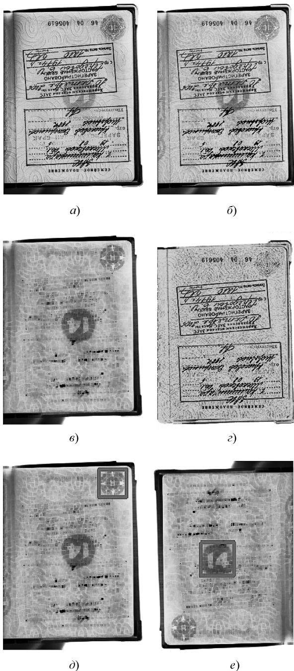
Рис. 3. Распознавание страницы паспорта гражданина РФ: а) исходное изображение (в перевернутом виде); б) морфологическая фильтрация типа «размыкание»; в) выделенное изображение фона; г) выделенное изображение печатей; д) определение ориентации страницы; е) распознавание номера страницы
