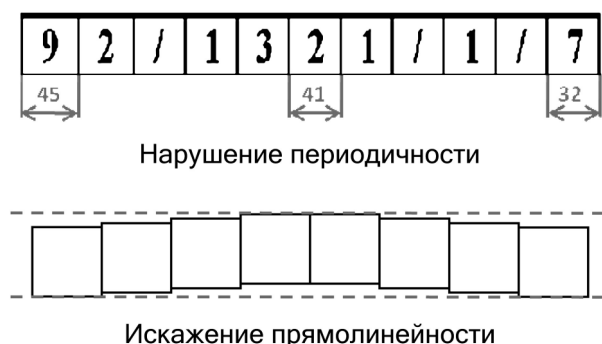
Рис. 3. Примеры деформаций решеток знакомет.
