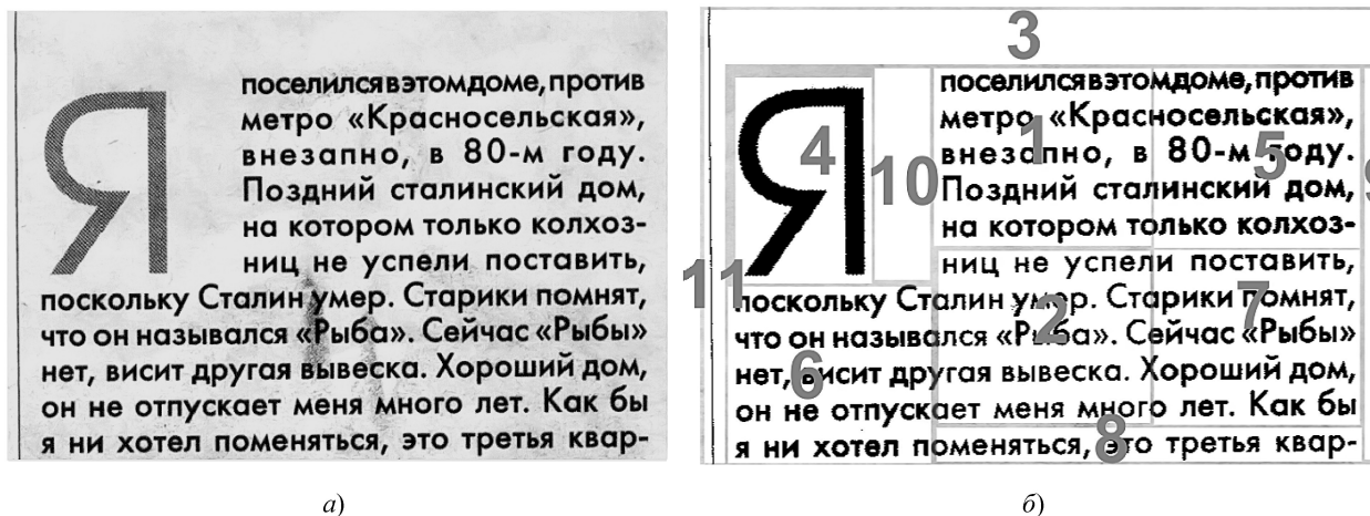
Рис. 5. Области разметки: а — исходное изображение; б — размеченное изображение. Цифрами обозначен порядок добавления областей к разметке
