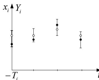
Рис. 2. Исходные временные ряды фактического и прогнозируемого спроса и точечная аппроксимация прогнозов: ● – факт  $x_i$ ,  $\bar{\phantom{y}}$  – отрезок прогноза  $Y_i$ , ○ – аппроксимация  $y_i$
