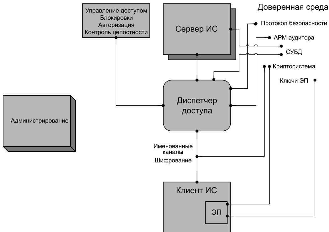
Рис. 1. Архитектура СЗИ ИС
