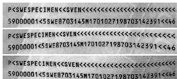
Рис. 3. Нелинейные искажения строк машиночитаемой зоны после проективного исправления изображения документа (цитируется по [4])
