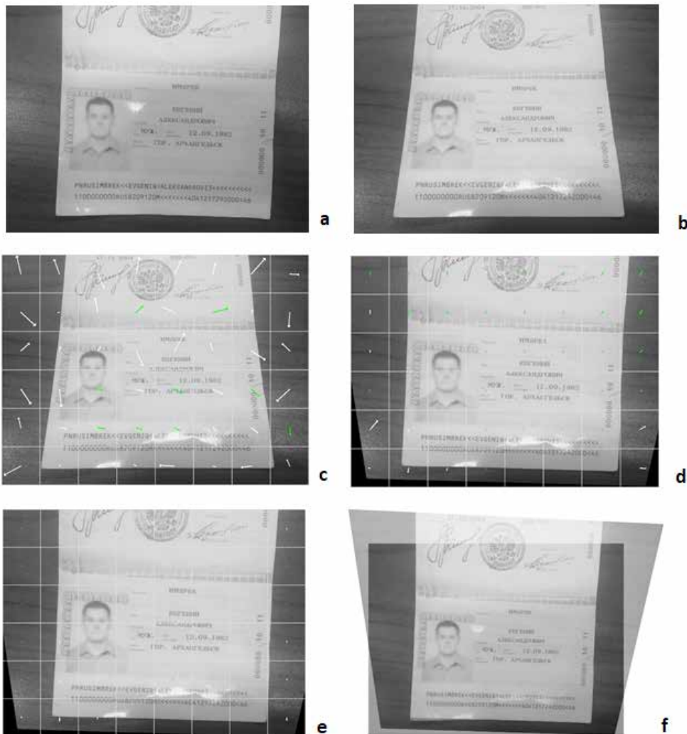
Рис. 6. Опорное (a) и локальное (b) изображения; векторные поля первой (c), второй (d) и третьей (e) итерации; f – совмещение опорного и финального изображений
