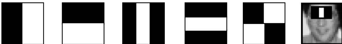
Рис. 2. Признаки Хаара и пример расположения признака относительно сканирующего окна
