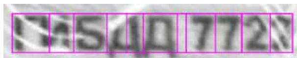
Рис. 2. Пример ошибочной сегментации текстовой строки на отдельные символы в условиях размытости изображения и дефектов, связанных с защитным голографическим слоем документа
