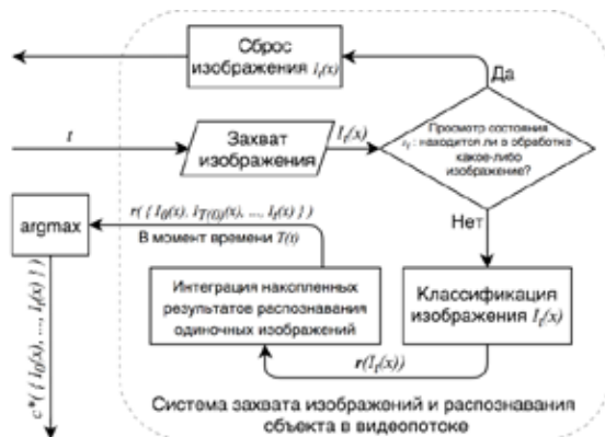
Рис. 5. Схема системы распознавания объекта в видеопотоке с тривиальной моделью обслуживания, преобразующей видеопоток в последовательность обрабатываемых изображений
