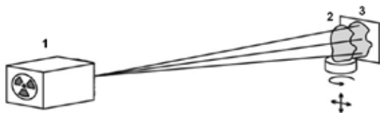
Рис. 1. Принципиальная схема рентгеновского компьютерного томографа: 1 – источник рентгеновского излучения; 2 – изучаемый объект на гониометрическом держателе; 3 – регистрирующее устройство
