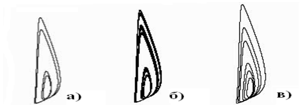
Рис. 1. Проекция на плоскость (z, y) устойчивого цикла периода 4 субгармонического каскада бифуркаций при k \approx 10.105 (а), аттрактора Фейгенбаума при k \approx 10.0945 (б) и цикла периода 6 при k \approx 10.086 (в)
