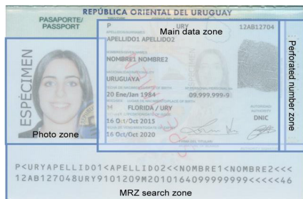
Рис. 4. Зоны поиска полей на фотографии и странице паспорта Уругвая (образец изображения из Wikimedia Commons)
